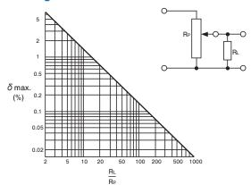
ポテンショメータの出力端に、負荷抵抗:RL が加わると、ポテンショメータの直線度は、次の式で計算される値だけ、最大で悪くなります。 When resistance RL is applied to the output terminal of the potentiometer, the linearity of the potentiometer is decreased by a maximum of the value shown in the following equation.
